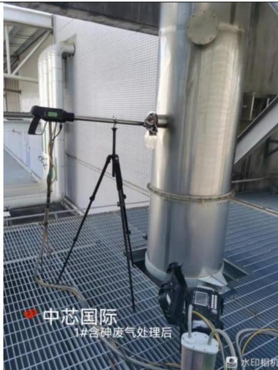
工艺废气（含砷）处理后采样口
